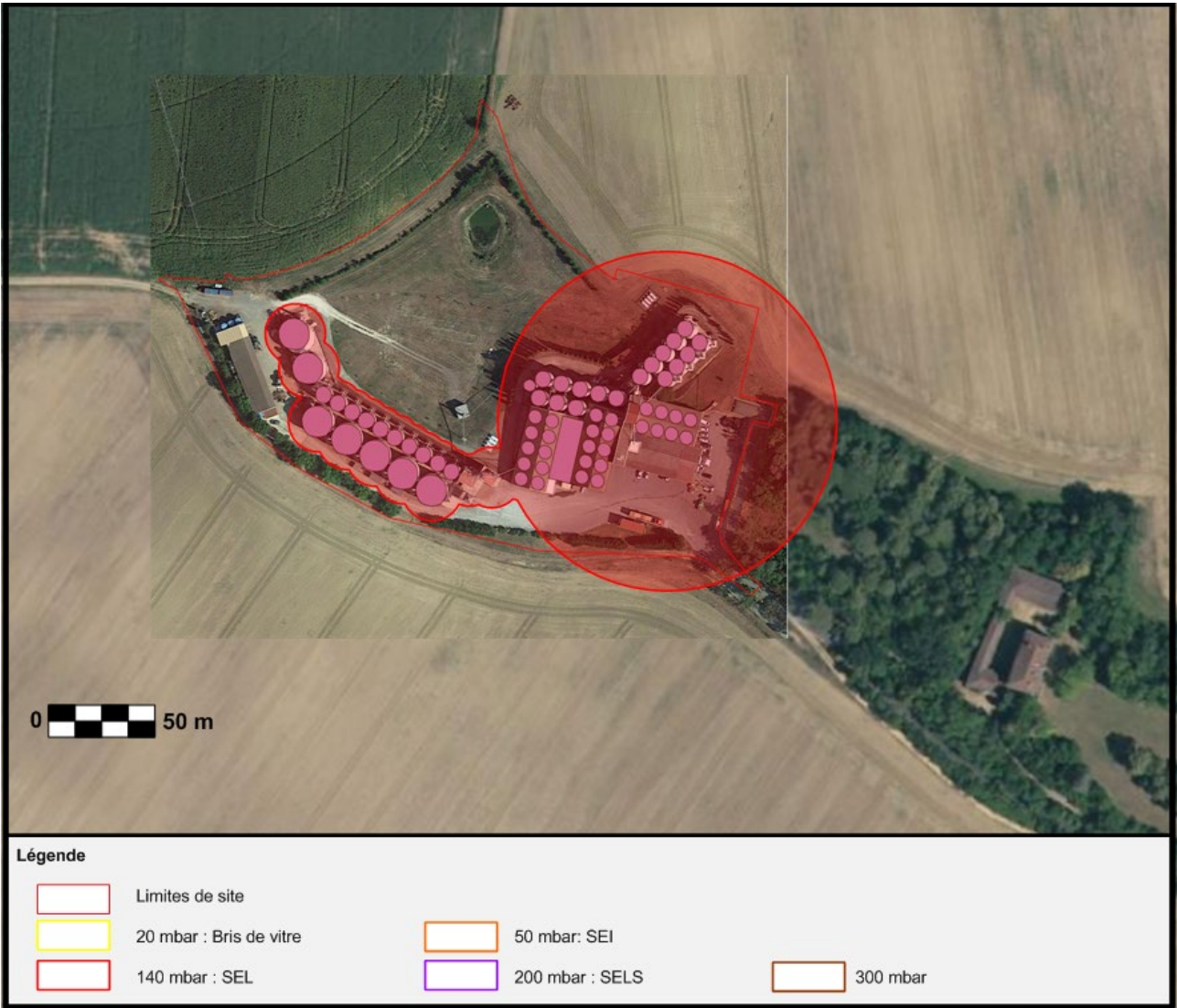
Figure 11 : Cartographie des effets de surpression à 140 mbar
