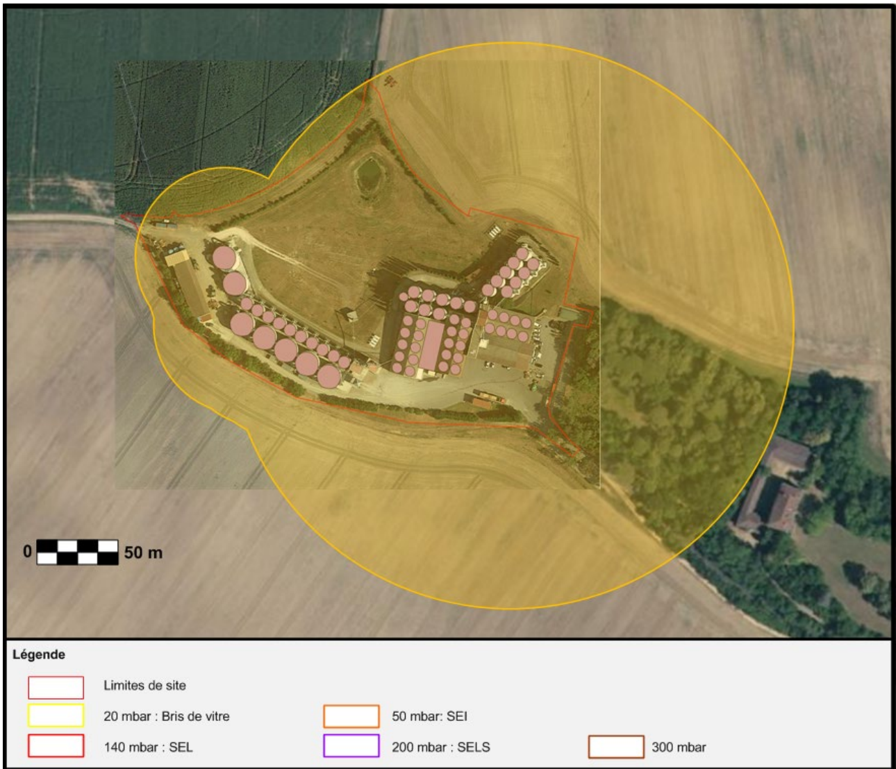
Figure 10 : Cartographie des effets de surpression à 50 mbar
