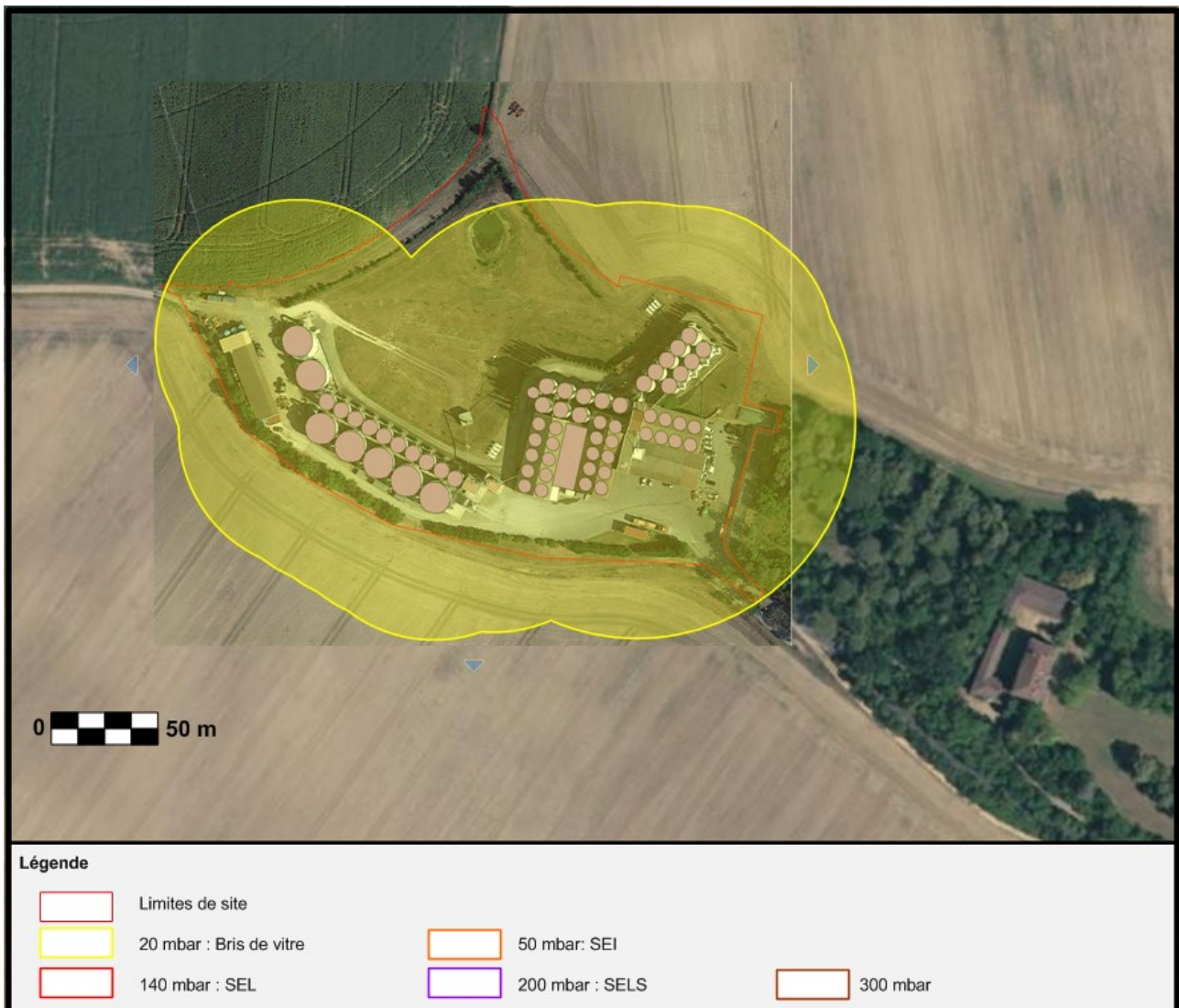
Figure 13 : Cartographie des effets de surpression à 20 mbar après découplage
