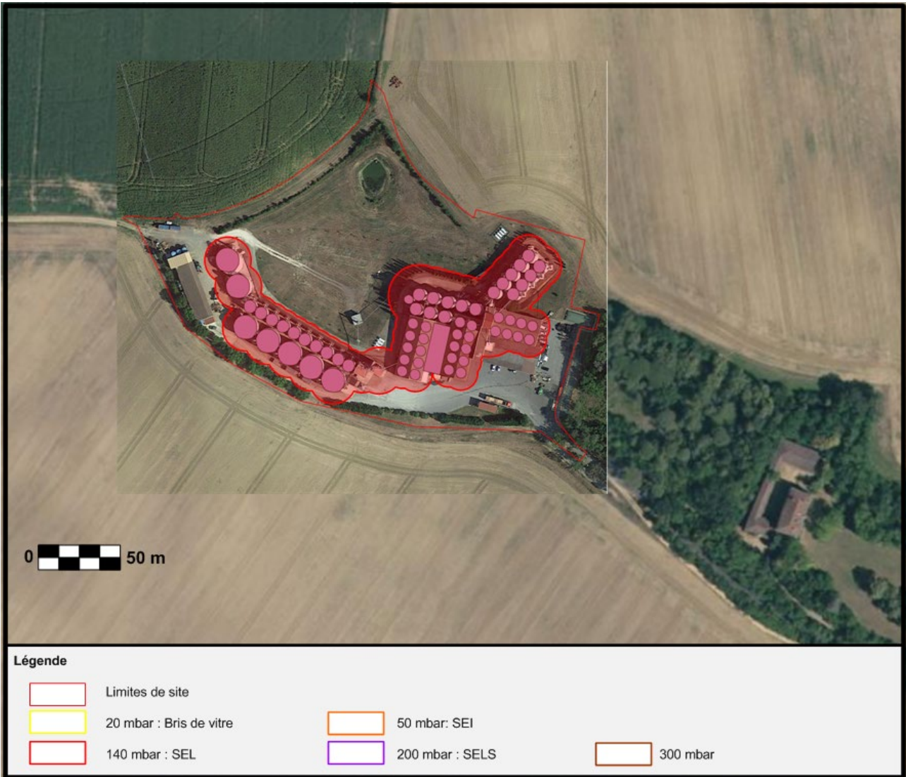
Figure 15 : Cartographie des effets de surpression à 140 mbar après découplage
