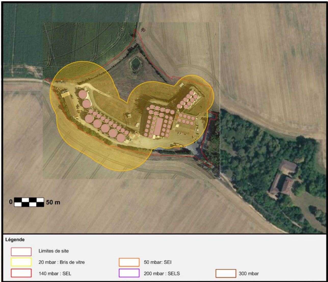
Figure 14 : Cartographie des effets de surpression à 50 mbar après découplage
