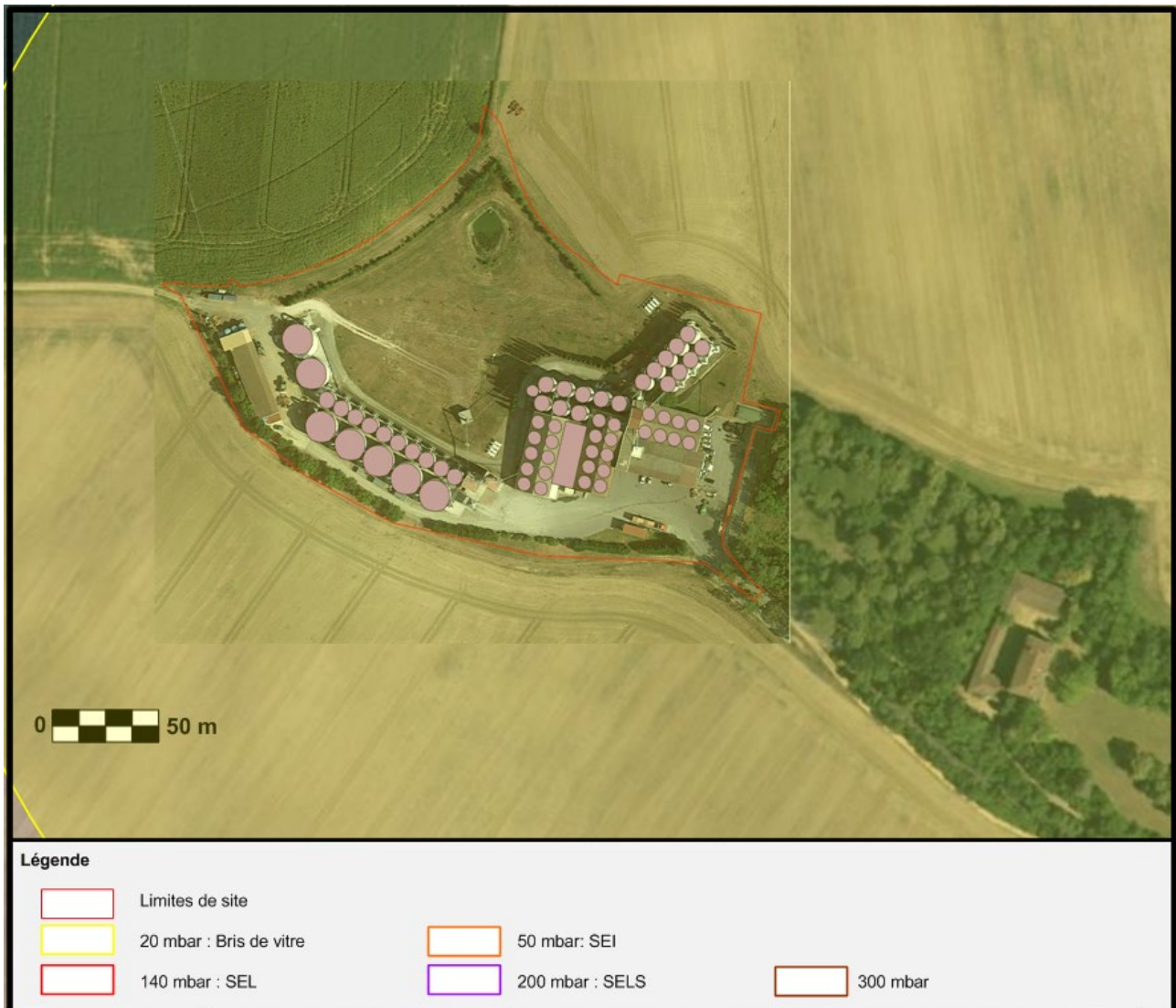
Figure 9 : Cartographie des effets de surpression à 20 mbar
