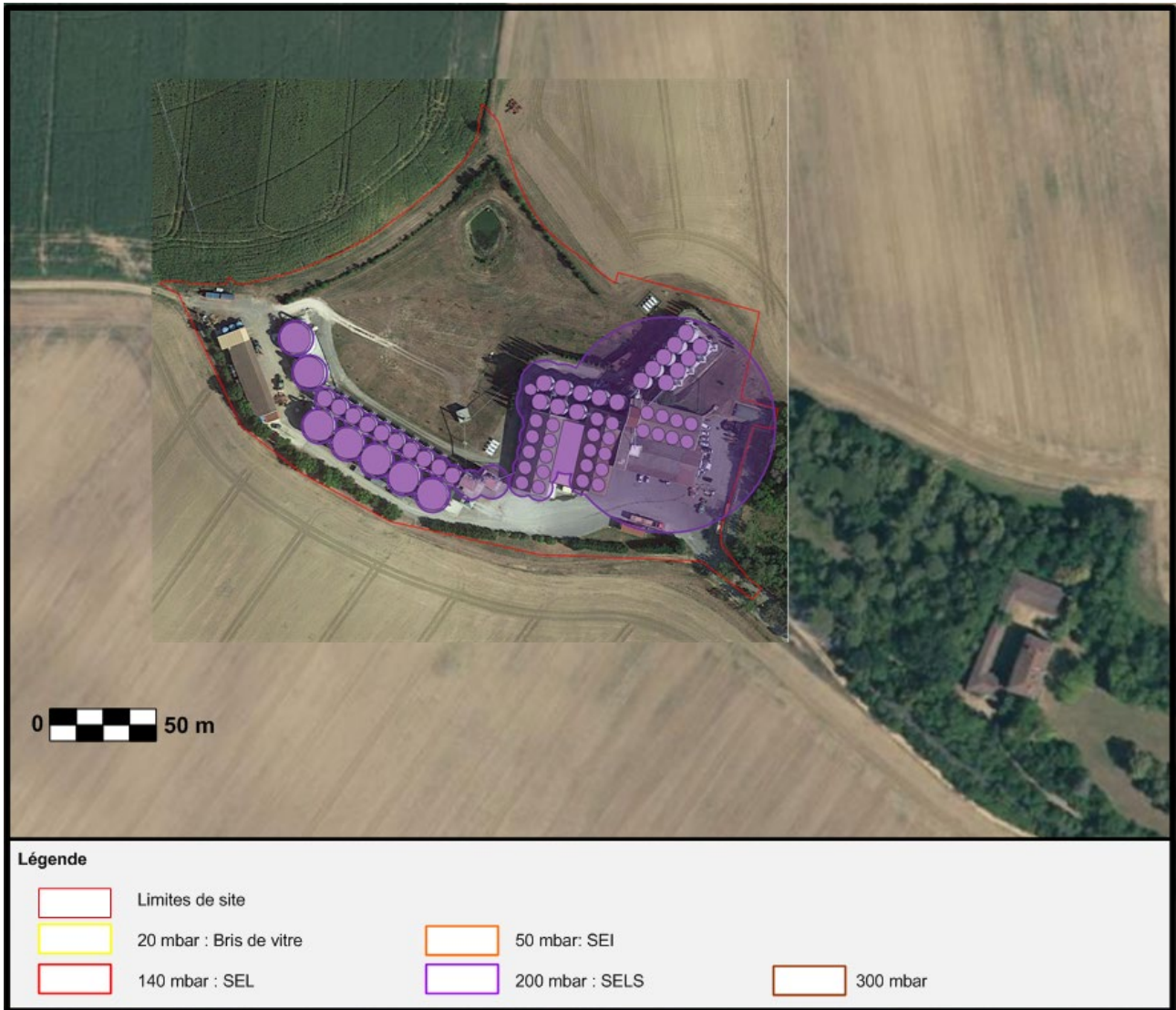
Figure 12 : Cartographie des effets de surpression à 200 mbar
