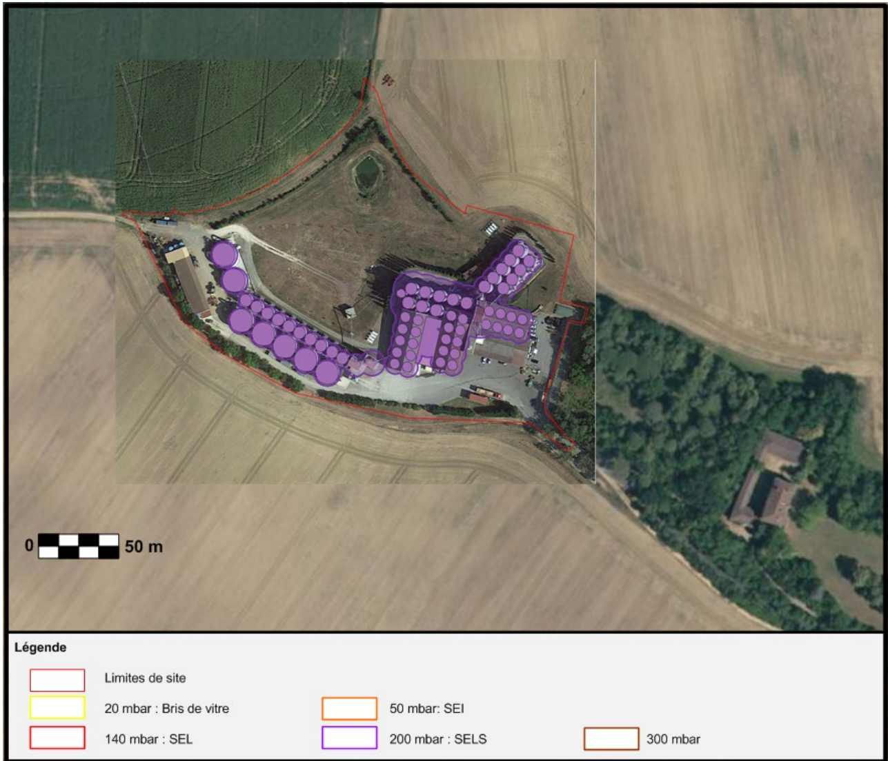
Figure 16 : Cartographie des effets de surpression à 200 mbar après découplage
